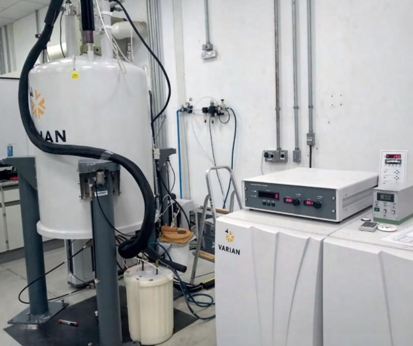
Espectrômetro de "Ressonância Magnética Nuclear, Varian 500 MHz
