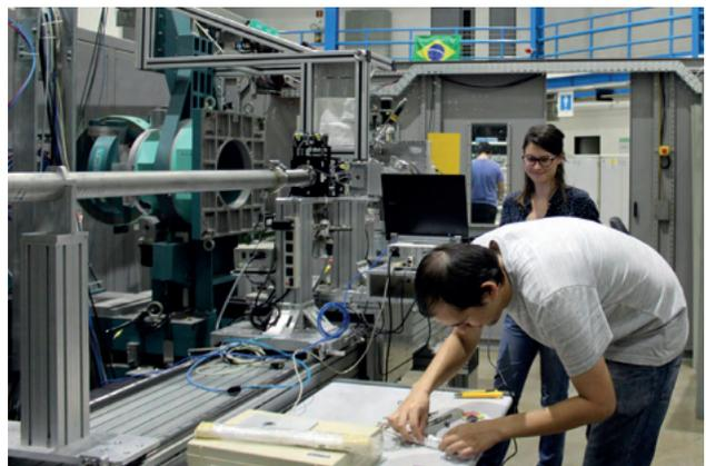
Figura 3 e 4: Fotos dos experimentos realizados por Espalhamento de Raios-X a Baixo Ângulo no Laboratório Nacional de Luz Síncrotron, para estudar a nanoestrutura dos hidrogéis.
