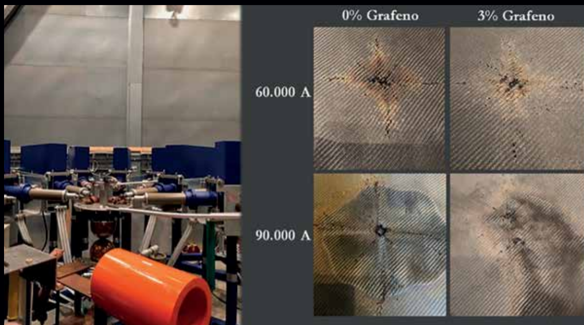
Equipamento para teste de queda de raios (Uppsala – Suécia) e superfícies das amostras de compósitos sem e com grafeno danificadas após o teste.
