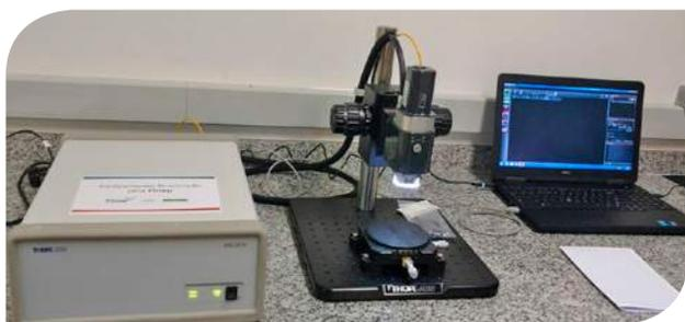
Foto: Tomógrafo por Coerência Óptica CALLISTO: Central Experimental Multiusuário
